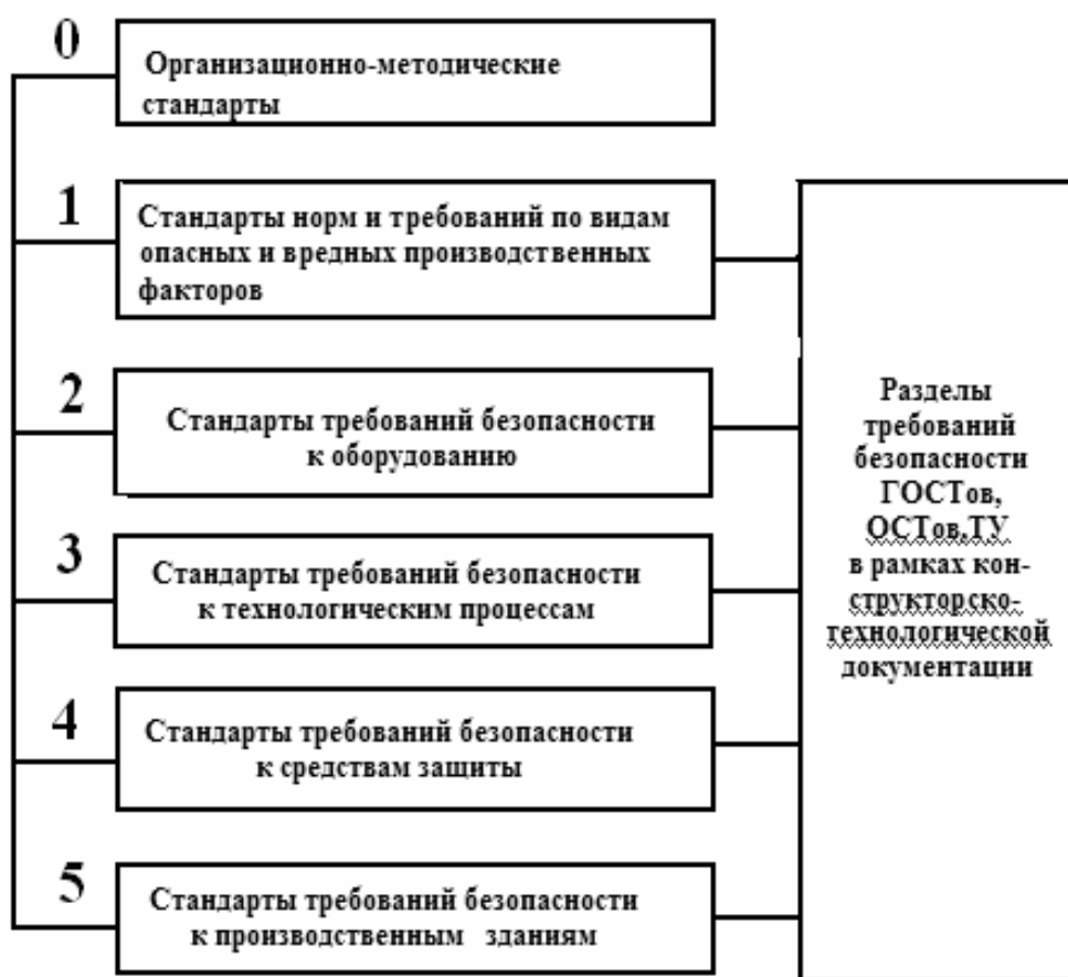
Рис. 3. Структурная схема Системы стандартов безопасности труда.
