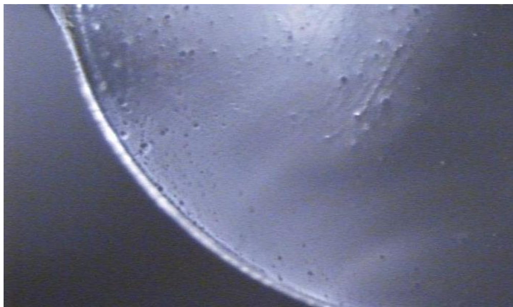
Рис.6. "Бугорки" на поверхности линзы (под микроскопом).
