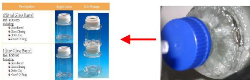
Рис. 7. Замена стеклянной емкости для полировки искусственного хрусталика на другой сосуд из другого материала.
